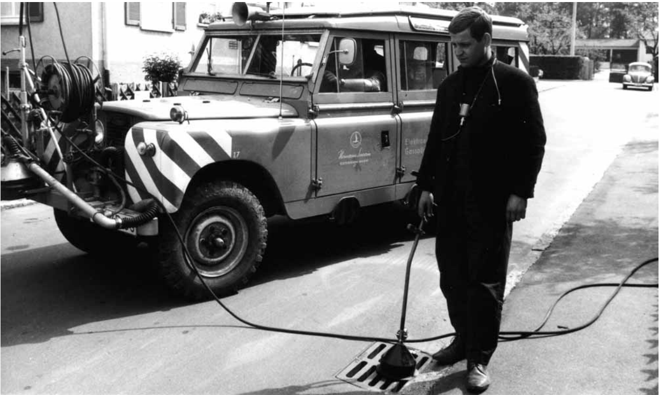
Abb. 1.3: Gasspürfahrzeug der TWS
