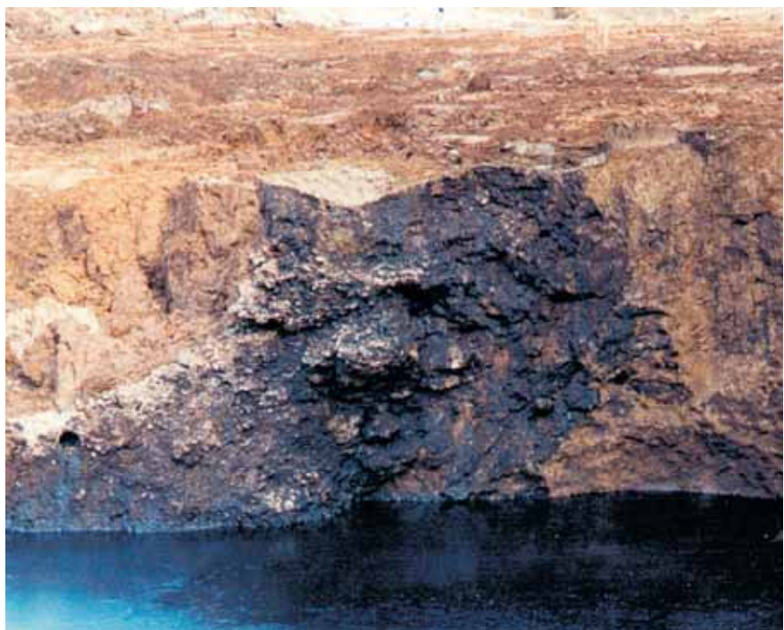
Abb. 7.2.3: Teeröl durchsickert den Auelehm (17.06.1995).
