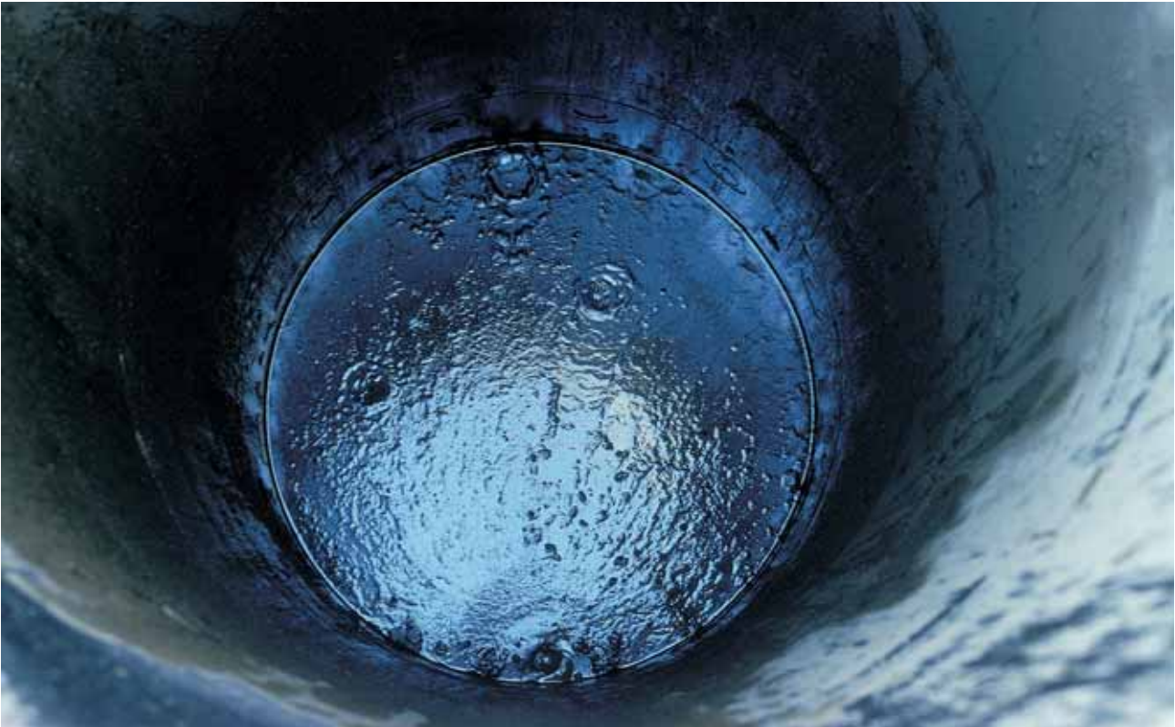
Abb. 7.2.8: Teeröl in einer Großlochbohrung (1995).
